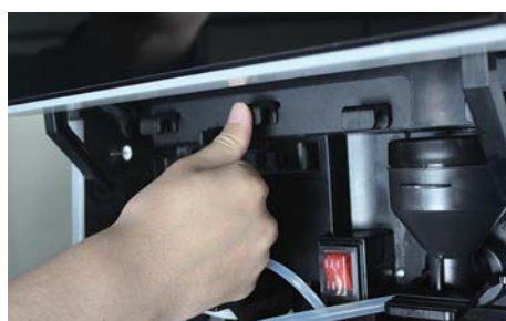
7. Wepchnąć suwak blokujący do końca do środka
