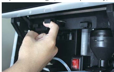
3. Pociągnąć suwak blokujący maksymalnie do przodu
